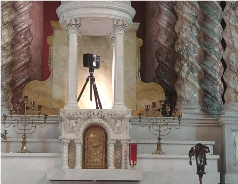
Rysunek 3.3. Ekstremalne umiejscowienie skanera w trakcie skanowania budynku kościoła św. Wojciecha w Chicago.
